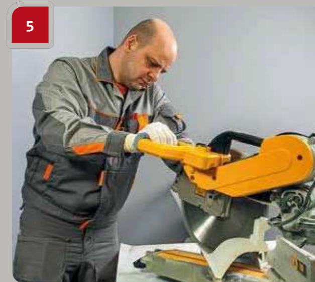
5 Mit einer Kappsäge das Element im entsprechenden Winkel ausschneiden. In einem Raum mit 90°-Winkel kann eine Gehungssäge oder eine Handsäge eingesetzt werden.
